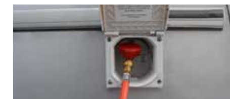
Außenanschluss am Wohnwagen/Wohnmobil nur für 30mbar-Geräte
