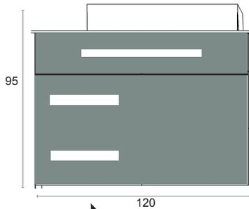
feste Rückwand mit Ausschnitten für Belüftung Gasflasche
