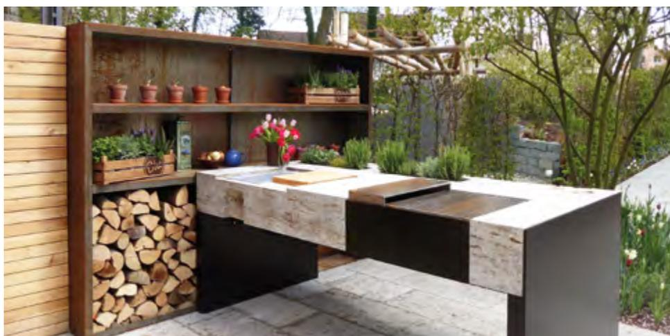
Gartenkamin Sonderanfertigung aus Cortenstahl, doppelwandig mit Luftführung, Ascheschublade und Rauchabzug.
