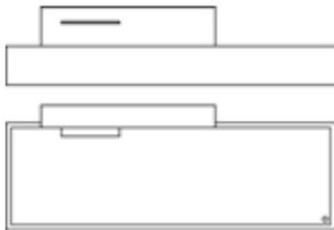
AQUA Wasserobjekt, Wasserbecken 3400 x 1100 x 5 mm, Höhe 400 mm, obere Abkantung 50 mm, mit Pumpenschacht, MECONDO 2-Komponenten-Korrosionsschutz für Unterwasserbelastung, Ab- und Überlauf, Wasserwand 2 mm Corten, 1800 x 800 x 225 mm
