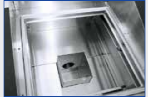
Lüftungskanal für das stufenlose regulierbare Gebläse Ventilation trunk for the steplessly adjustable fan
